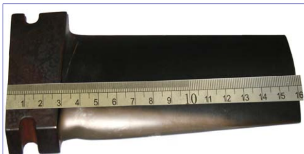
شکل ۲: وضعیت و شدت خرابی در روی پره (لبه حمله)
